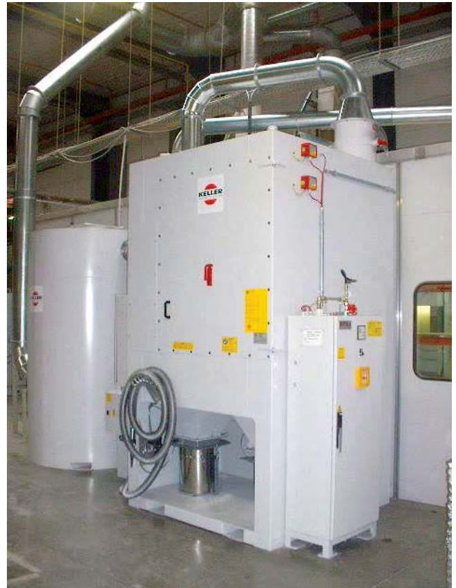
Façonnage laser du bois, environ 3000m 3 /h
