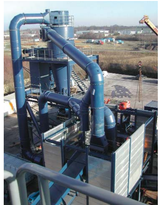
Classificateur RBA après un broyeur de 1 400 CV
